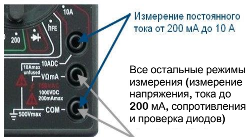
Рис. 1.16. Гнезда для подключения щупов
