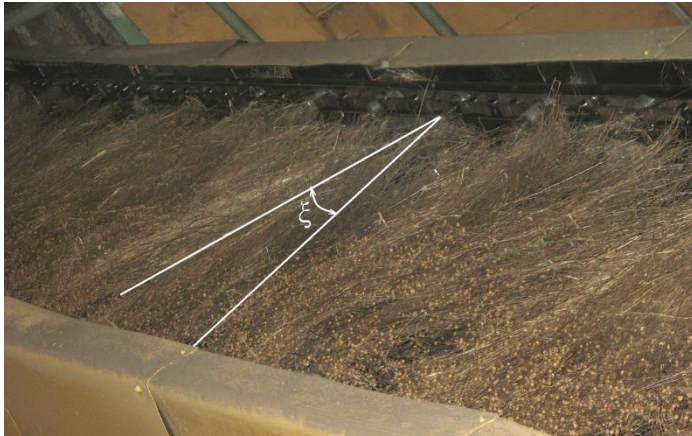
Рис. 3.1. Схема определения угла перекоса стеблей в ленте льнотресты в линии первичной переработки
