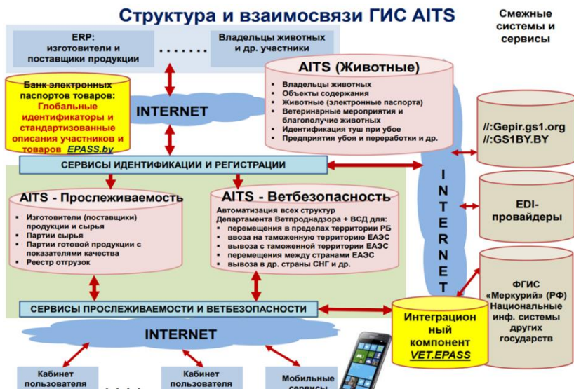
Рис. 1. Принцип функционирования государственной информационной системы ГИС АИТС
