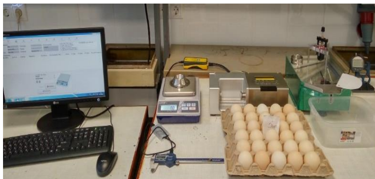
Рис. 3. Специализированное оборудование Broring informationstechnologie для оценки морфологических качеств яиц с.-х. птицы
