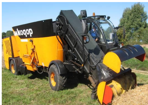
Рисунок 3 – Опытный образец самоходного смесителя-раздатчика кормов ССР –12
