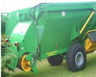
Рисунок 1 - Вид на погрузчик-раздатчик-смеситель кормов ПРСК-12 со стороны фрезбарабана
