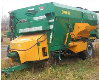
Рисунок 2 - Загрузчик-раздатчик кормов ЗРП-12
