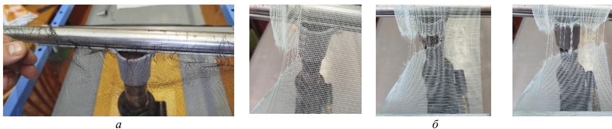
Рис. 3. Разрыв сетчатой ленты из стекловолокна (а), разрыв сетчатой ленты из полиэфира (б)
