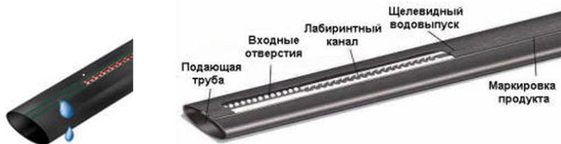
Рис. 13.4. Микроводовыпуск, встроенный в капельную линию
