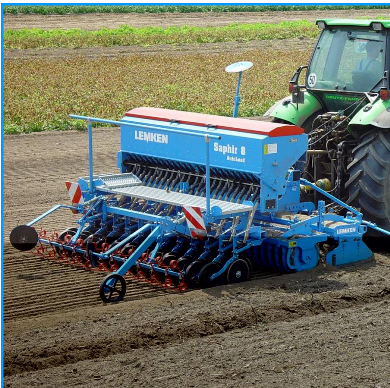
Рис. 7. Агрегат из вертикально-роторной бороны ЦИРКОН и сеялки САПФИР.
