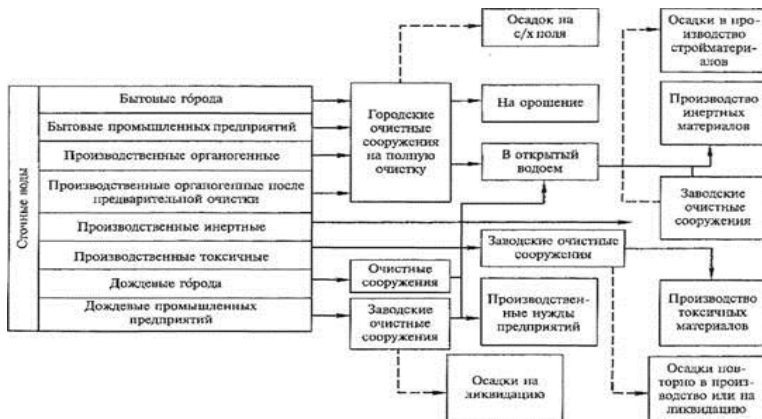
Рис. 3.6. Граф возможных вариантов водоотведения и рационального использования очищенных сточных вод при полной раздельной системе
