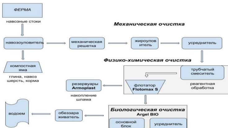
Рис. 7.13. Схема очистки сточных вод животноводческого комплекса
