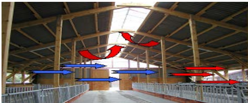
Рис. 27. Схема движения воздушных масс в коровнике
