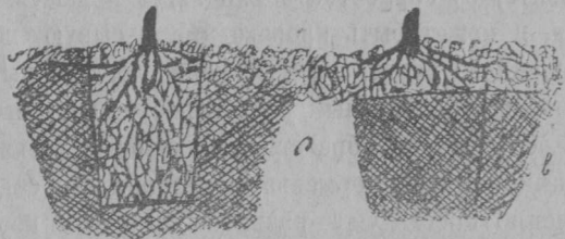
Рис. 8. Слева при копании ямы захвачена большая часть непроницаемого слоя. Справа: яма выкопана только в верхнем проницаемом слое: а—проницаемый слой почвы, б—непроницаемый слой.
