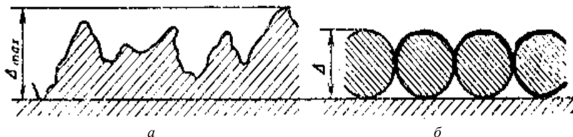
Рис. 10.5. Естественная (а) и эквивалентная зернистая (б) шероховатости
