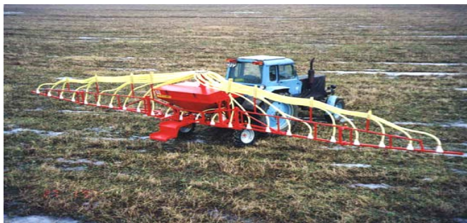
Рис. 10. Пневматический штанговый рассеиватель удобрений СУ-12-01
