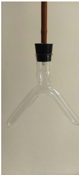
Рис. 7.3. Прибор для определения активности каталазы КАТ-1
