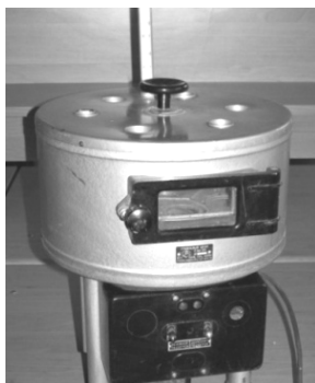
Рис. 10.1. Сушильный шкаф СЭШ-3М
