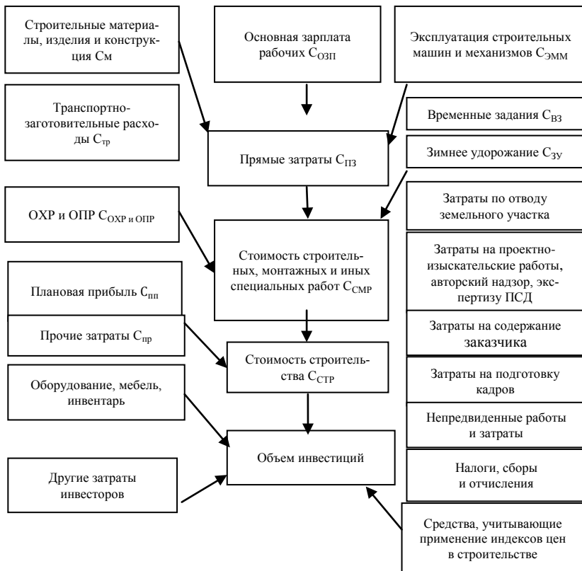
Рис. 3.1. Порядок формирования стоимости строительства
