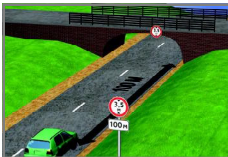
Рис. 3. Табличка 7.1.1 указывает расстояние от знака до места введения ограничения движения
