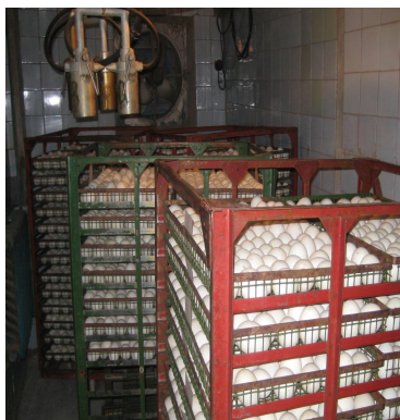
Рис. 147. Камера для аэрозольной обработки яиц формалином
