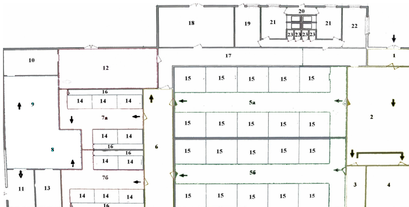
Рис. 29. Проект инкубатория с производственными помещениями:
