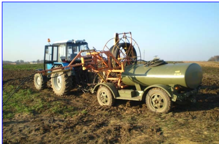
Рис. 6.24. Общий вид дренапромывочной машины ДП-10А
