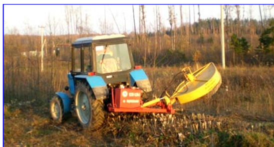
Рис. 4.21. Однороторная четырехножевая косилка КР-1,3
