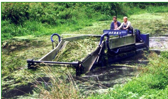
Рис. 4.99. Плавающие косилки с накопителями срезанной растительности
