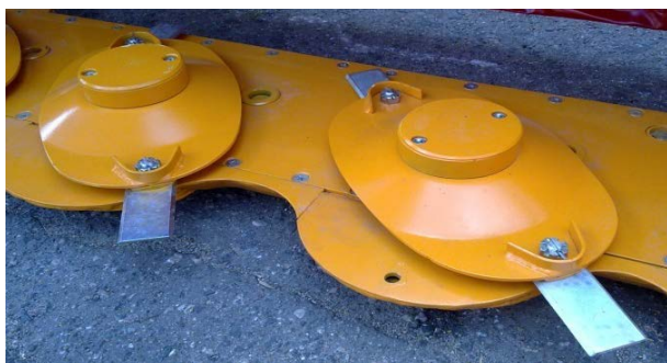
Рис. 4.38. Многороторный рабочий орган с вынесенными вперед осями вращения роторов: а – схема; б – фрагмент режущего аппарата
