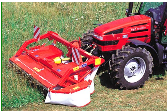
Рис. 4.48. Многороторная косилка с фронтально навешенным режущим аппаратом
