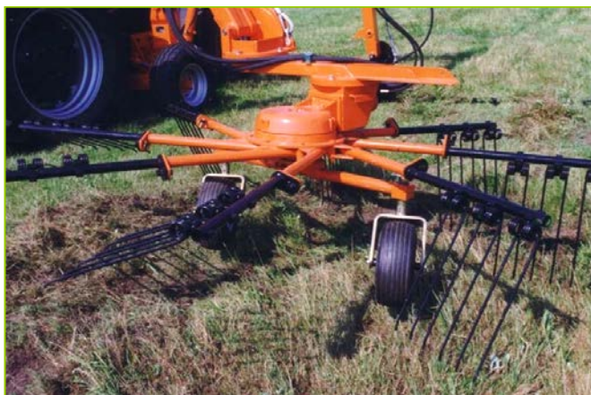
Рис. 4.77. Роторный рабочий орган с гидроприводом подборщика срезанной растительности
