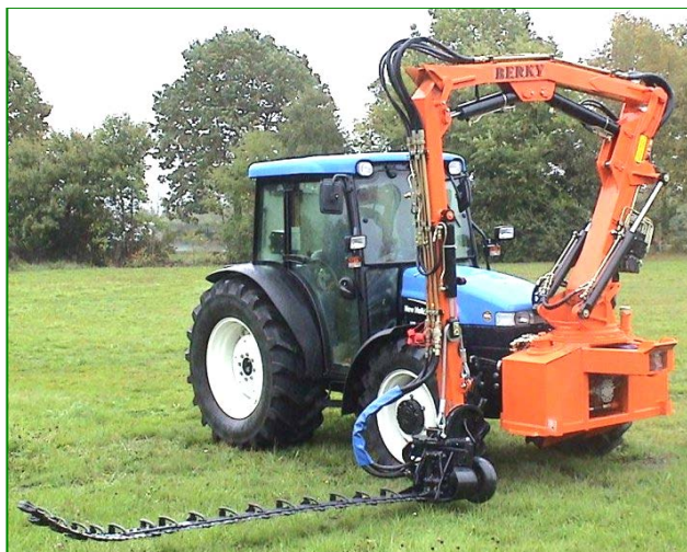
Рис. 4.11. Косилка с изогнутым двухножевым режущим аппаратом
