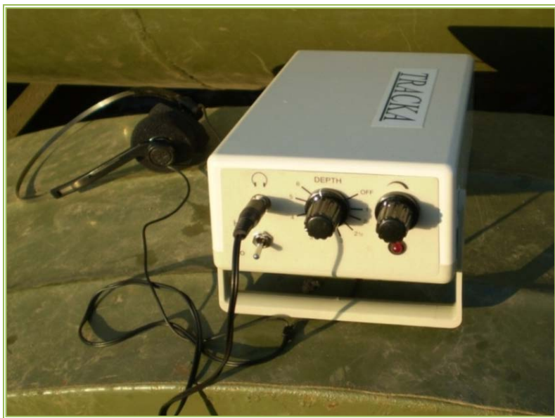
Рис. 6.36. Прибор для определения положения дренапромывочной головки
