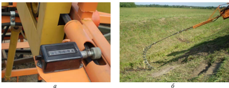
Рис. 6.29. Вид счетчика ( а ) для определения длины напорного шланга, вошедшего в дренаж, и дугообразной направляющей ( б )
