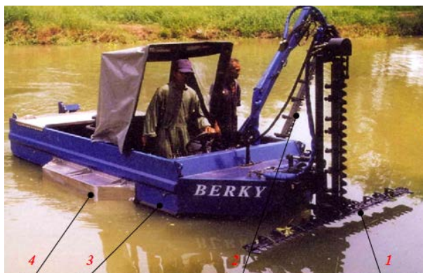
Рис. 4.90. Косилка с основным Т-образным и боковым рабочими органами: 1 – основной рабочий орган; 2 – дополнительный боковой рабочий орган; 3 – борты мотобота; 4 – дополнительные понтоны
