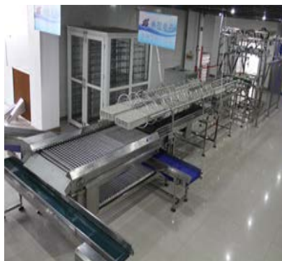
Рис. 41. Машина для перемещения инкубационных яиц
