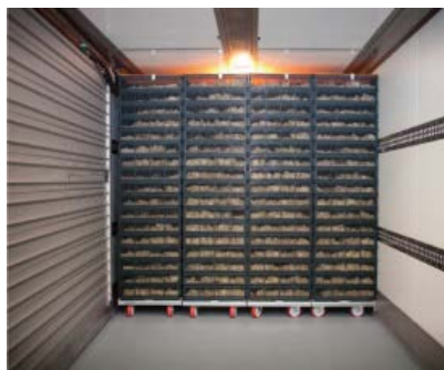
Рис. 50. Размещение ящиков с цыплятами в «ХечТревеллере»
