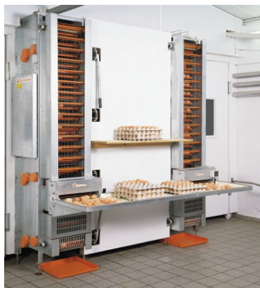
Рис. 8. Этажерочная система сбора яиц
