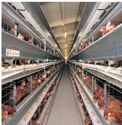
Рис. 3. Клеточная батарея «Универт» для кур-несушек фирмы Big Dutchman
