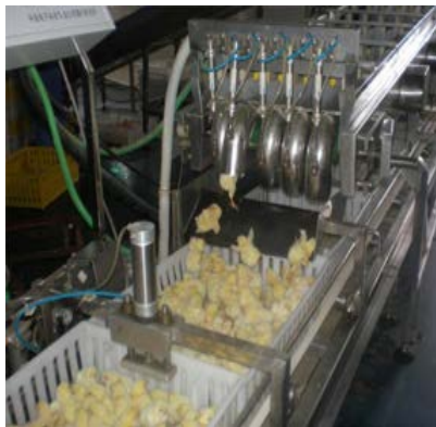
Рис. 44. Система подсчета и упаковки птенцов
