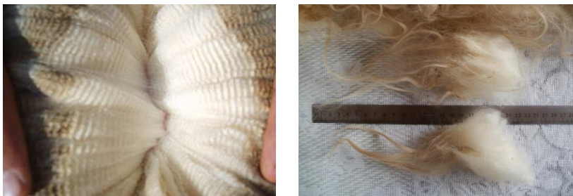
Рис. 4.1. Образец однородной и неоднородной шерсти
