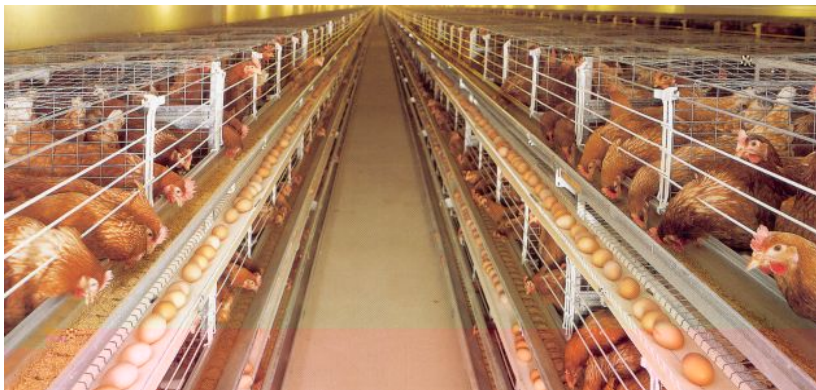
Рис. 3.5. Клеточная батарея для содержания кур-несушек «Унивент-Л» (характеристики (УВ-Л1500, УВ-Л1500а/УВ-Л1500А, УВ-Л1550, УВ-Л1550а/УВ-Л1550А, УВ-Л1600): тип кормораздачи – цепная; система поения – ниппельная; уборка помета – ленточная; сбор яиц – ленточный; ширина блока клеточного (батареи) – соответственно 1 320, 1 420, 1 420, 1 520, 1 520 мм; количество ярусов – 3–8 шт.; длина клеточного блока – 2 412 мм; расстояние между ярусами – 590 мм; количество клеток в клеточном блоке – 8; ширина клетки – 603 мм; глубина клетки – соответственно 500, 500, 550, 550, 600 мм; площадь клетки – соответственно 3 015, 3 015, 3 316, 3 316, 3 618 см 2 ; удельная площадь клетки на одну птицу – 372 см 2 ; производительность системы кормления – 13 т/ч; производительность системы сбора яиц – 30 000 шт/ч)
