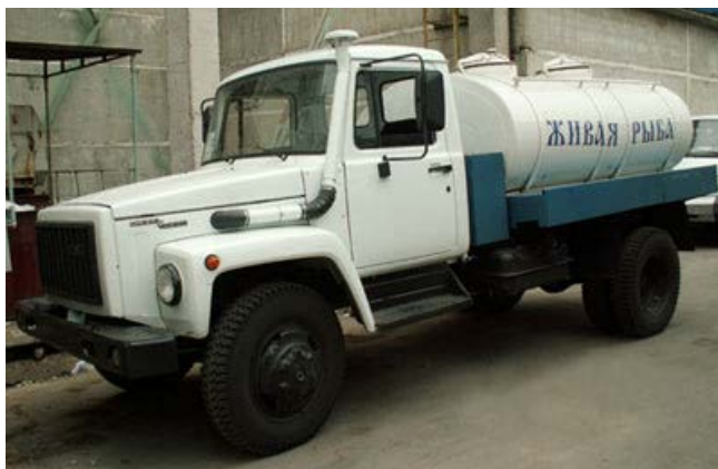
Рис. 60. Автоцистерна АЦПП-2,8 смонтирована на шасси автомобиля ГАЗ-53А6
