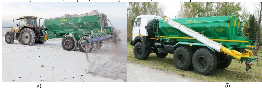
Рис. 1. Машины для внесения пылевидных химмелиорантов: а) прицепная машина МШХ-9, б) самоходная машина МХС-10
