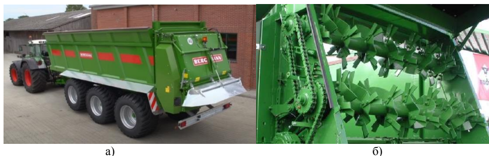
Рис. 2. Универсальный разбрасыватель TSW 7340S фирмы «BERGMANN»: а) общий вид; б) фрезерный агрегат
