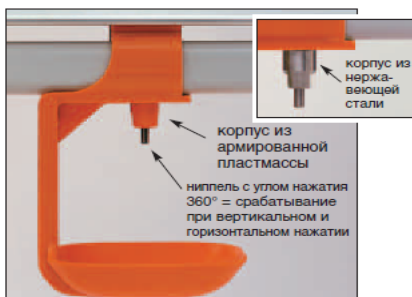
Рис. 58. Устройство ниппельной поилки для птицы
