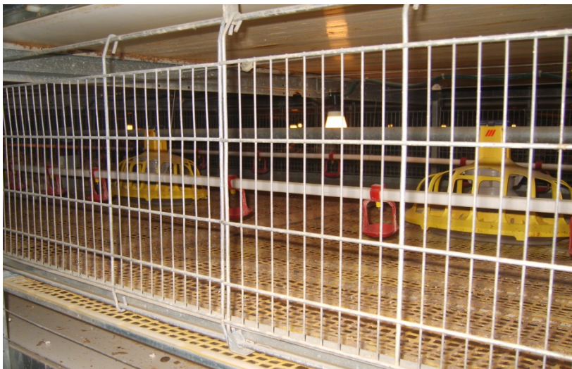
Рис. 64. Клеточная батарея для содержания бройлеров
