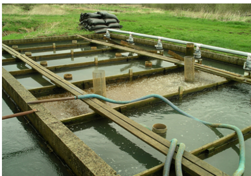
Рис. 5.21. Классический погружной биофильтр в одном из форелевых рыбоводных хозяйств
