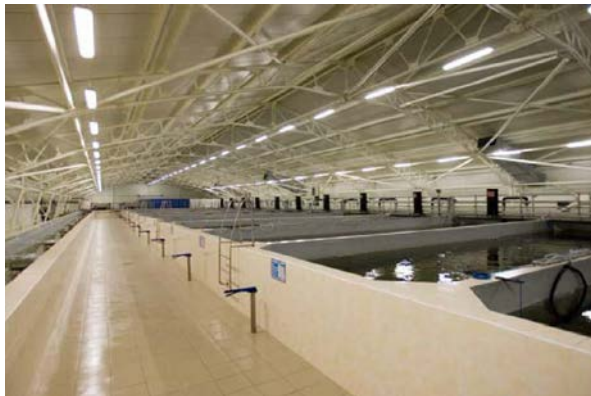
Рис. 19. Рыбоводные бассейны объемом 50 \text{ м}^3 каждый – 16 шт. Всего в бассейнах 800 \text{ м}^3 воды
