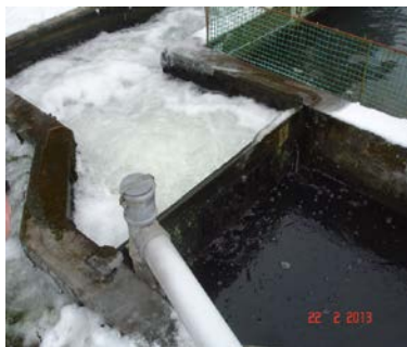
Рис. 5.55. Эрлифт в процессе работы
