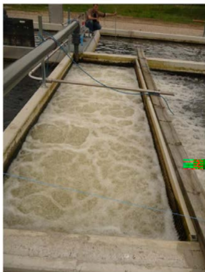
Рис. 5.5. Работа эрлифта в действующих рыбоводных хозяйствах (пример 1)
