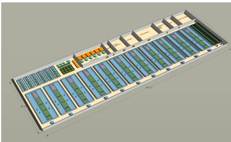
Рис. 15. Схема УЗВ с бетонными прямоугольными бассейнами (вариант 2)
