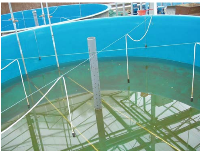
Рис. 5.11. Максимальная аэрация воды в некоторых УЗВ Китая (пример 3)
