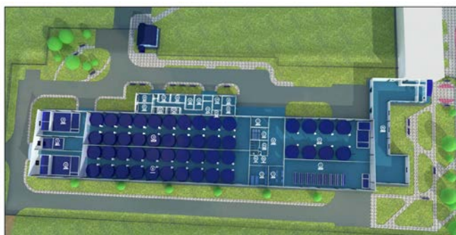
Рис. 6. В состав рыбоводного промышленного комплекса УО БГСХА входит четыре модуля: модуль инкубации, модуль выращивания молоди до массы 5 г, два модуля выращивания молоди до массы 50 г
