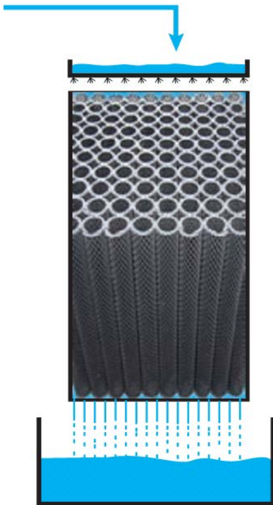
Рис. 5.7. Схема работы дегазатора
