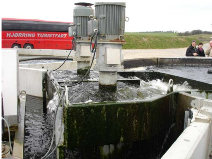
Рис. 6. Два насоса для платформ с инжекторами
