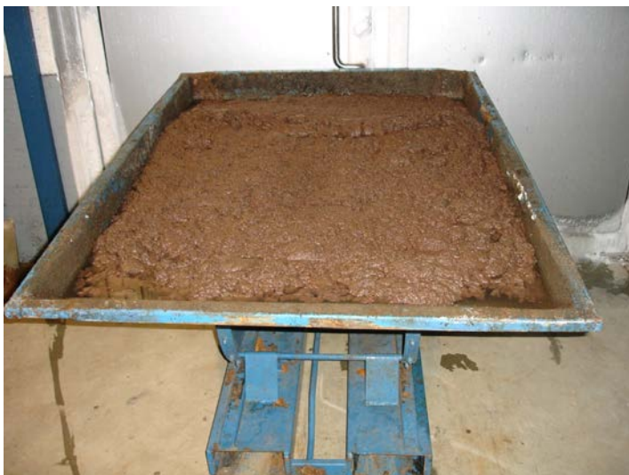
Рис. 5.28. Условно твердая фракция из сточных вод УЗВ
