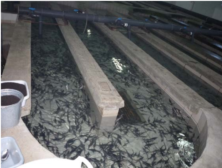
Рис. 26. Бетонный бассейн овальной формы
