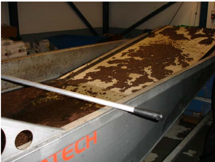
Рис. 5.27. Сепаратор для сточных вод из УЗВ
