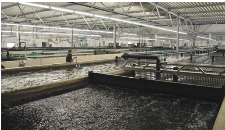
Рис. 17. Схема УЗВ с бетонными прямоугольными бассейнами (вариант 4)
