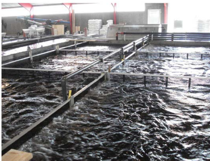
Рис. 6. Биологический фильтр с плавающей подвижной загрузкой
