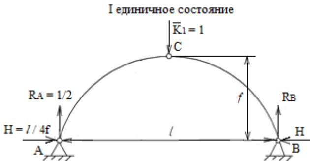
Рис. 7.22. Расчетная схема первого единичного состояния
