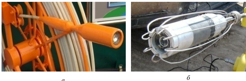
Рис. 6.41. Видеокамера с генератором сигнала комплекса КСД-160 в разных исполнениях
