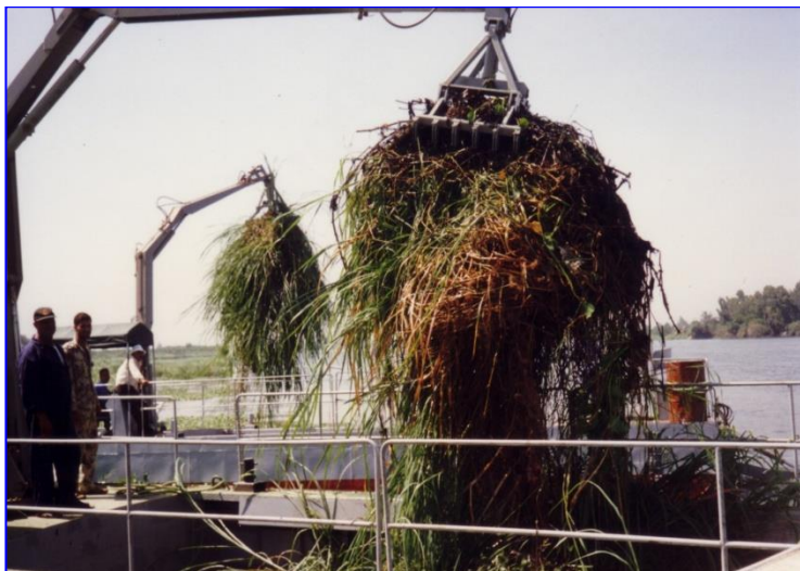
Рис. 4.88. Процесс выгрузки из бункера срезанной водной растительности
