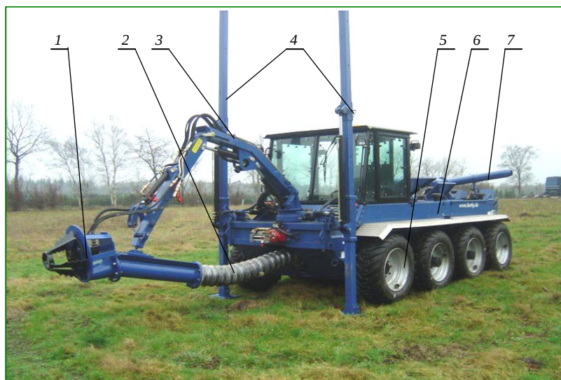
Рис. 8.5. Земснаряд-амфибия на многоопорном шасси с независимым поворотом грунтозаборного органа и свайными опорами: 1 – грунтозаборный орган; 2 – гибкая вставка; 3 – поворотная стрела; 4 – вертикальные опоры; 5 – пневматическое шасси; 6 – корпус; 7 – выбросная труба
