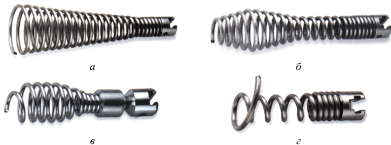
Рис. 6.6. Спиральные насадки для механической прочистки труб: а – конусная; б – грушевидная; в – грушевидная с зацепом; г – крюкообразная
