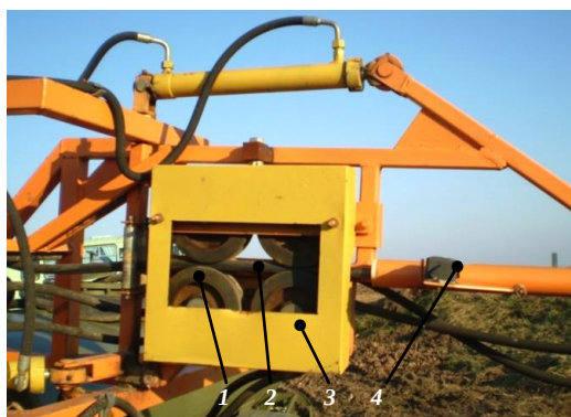
Рис. 6.28. Вид механизма для перемещения напорного шланга: 1 – ролики; 2 – напорный шланг; 3 – кожух механизма; 4 – счетчик
