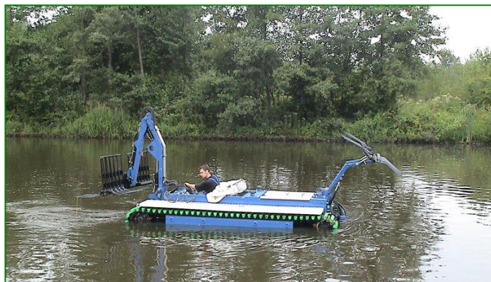
Рис. 4.83. Мотобот-амфибия для сбора срезанной растительности на гусеничном ходу
