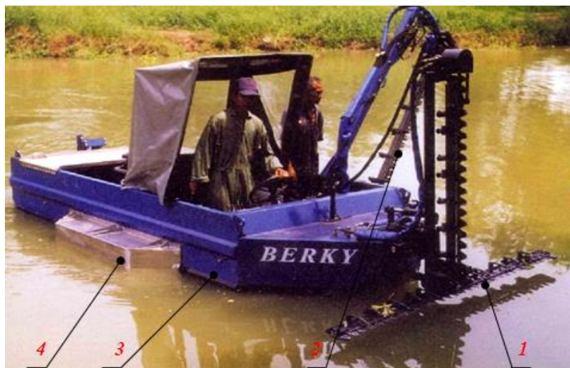
Рис. 4.75. Косилка с основным Т-образным и боковым рабочими органами: 1 – основной рабочий орган; 2 – дополнительный боковой рабочий орган; 3 – борты мотобота; 4 – дополнительные понтоны
