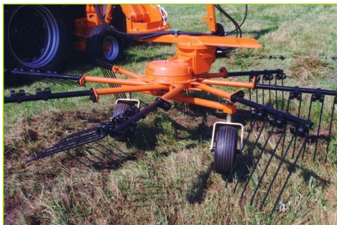
Рис. 4.62. Роторный рабочий орган с гидроприводом подборщика срезанной растительности
