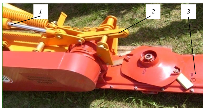
Рис. 4.46. Вид шарнирного устройства косилки АС-1: 1 – подъемный гидроцилиндр; 2 – серьга; 3 – режущий аппарат
