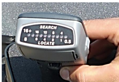
Рис. 6.44. Поисковое устройство ТЕСТА: а – вид в футляре; б – цифровая панель
