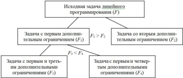
Рис. F1. Алгоритм решения целочисленной задачи линейного программирования методом ветвей и границ
