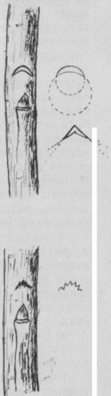
Рис. 8. Лунированіе или кербовка: I. по старому способу; сбоку—рисунки серповидной и крышеобразной вырѣзки. II. по новому способу; сбоку—геометрическая линия, означая движеніе лезвія ножа. Натур. вел. Пинцирирыя линія и рис. I. проведены для показанія того, что серп виднаго вырѣзка образуется отъ пересѣченія двухъ неравныхъ окружностей, а крышеобразная отъ пересѣченія двухъ неравныхъ угловъ.
