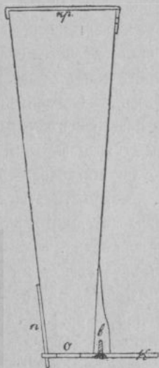
Рис. 16. Посѣвной рожекъ съ крышкою кр. и съ кружкомъ к. ; с —винтъ, держащій кружочекъ; п —пружина; о —отверстіе кружка.
