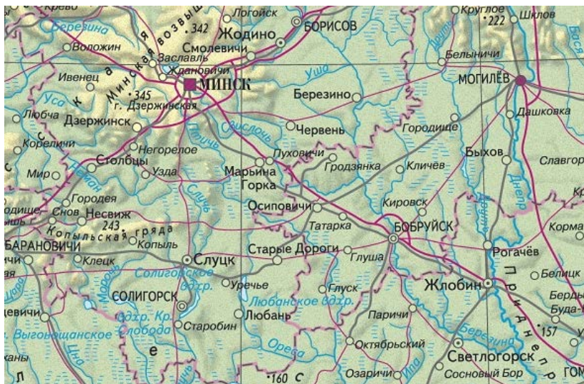
Рис. 19. Изображение рельефа способом отмывки
