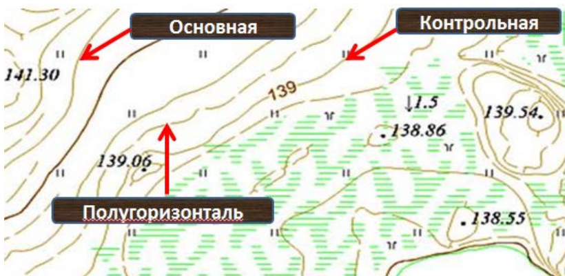
Рис. 20. Изображение рельефа с помощью горизонталей
