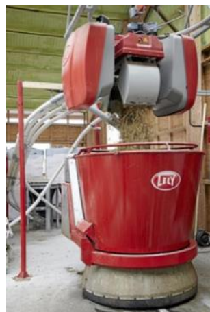
Рис. 3. Автоматизированные координатные смесители-раздатчики кормов: а – Innovado (Schuitemaker Machines B. V.); б – Vector (Lely)
