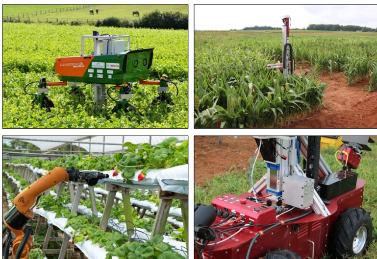
Рис. 1. Агророботы в уходе за посевами и в сборе урожая
