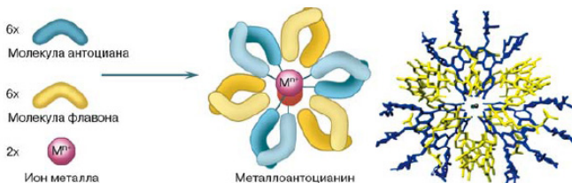
Рис. 2. Схема образования металлоантоцианина из шести молекул антоциана, флавона и двух ионов металла.
