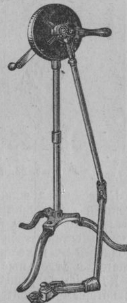
Рис. 32. Ручная машинка для стрижки овец
