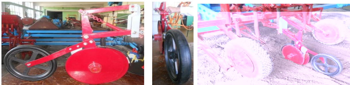
Рис. 4. Двухдисковый сошник с опорно-прикатывающим каточком фирмы Lemken: □ -1 5 , 2 1 , 3 1 , 4 4 , 5 1 , 6 3 , 7 2 , 8 1 , 9 7 , 10 8 , 11 8 , 12 8 , 13 3 , 14 3 , 15 8 , 16 3 , 17 6 , 18 5 , 19 2 , 20 6 , 21 1 , 22 3 , 23 6
