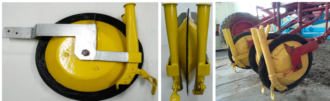
Рис. 1. Скоростной однодисковый сошник с двухсторонними симметричными ребордами-бороздкообразователями с нулевым углом атаки диска для узкорядного посева:
