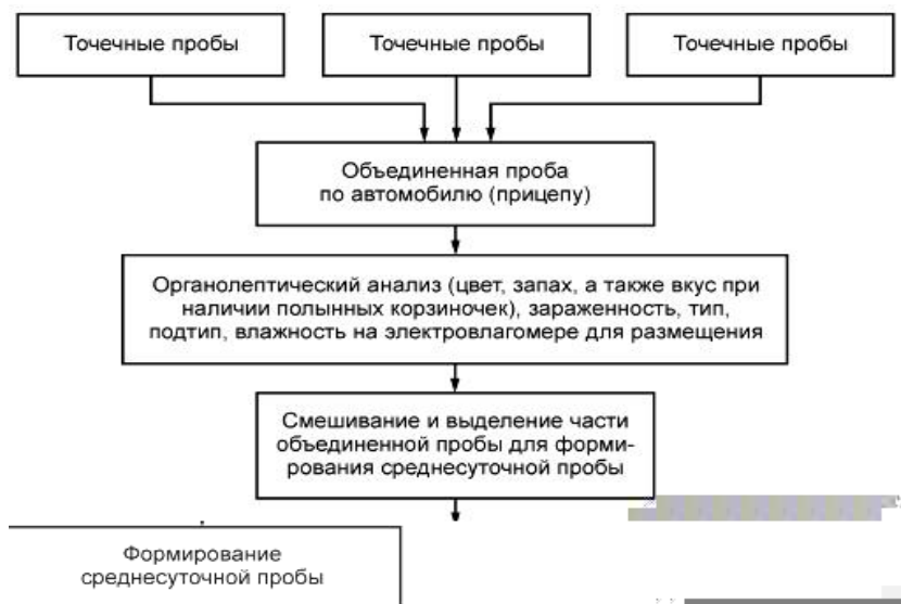
Рис. 2. Схема формирования среднесуточной пробы
