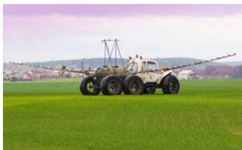
Рис. 2. Самоходная машина для внесения минеральных удобрений «РОСА»
