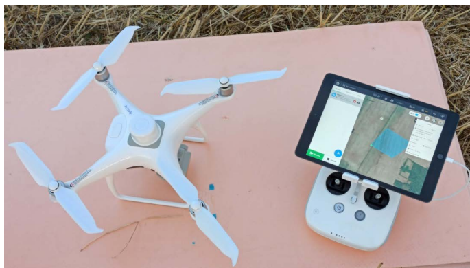
Рис. 1. Квадрокоптер с мультиспектральной камерой DJI Phantom 4 Multispectral
