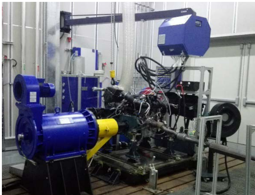
Рис. 1. Стенд для испытаний ДВС
