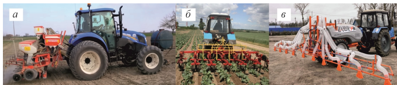
Рис. 1. Оборудование для внесения рабочих растворов ленточным способом: а – на сеялке; б – на культиваторе; в – опрыскиватель со специальной штангой
