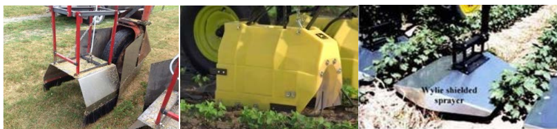
Рис. 3. Устройства, снижающие снос рабочих растворов при опрыскивании ленточным способом
