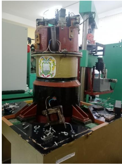
Рис. 1. Лабораторная установка с электромагнитным виброприводом
