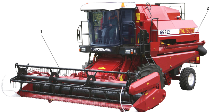
Рис. 5. Зерноуборочный комбайн «ПАЛЕССЕ GS812»: 1 – жатка для зерновых культур; 2 – молотилка самоходная
