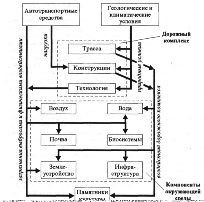
Рис. 8.1. Взаимосвязь воздействий автомобильно-дорожного комплекса и окружающей среды
