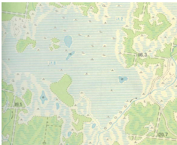
Рис. 3.2. Пример масштабных условных знаков: моховые и облесенные болота проходимые и непроходимые, заболоченные земли
