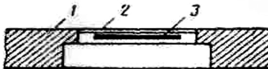
Рис. 2.5. Преобразователь давления с тензорезистором: 1 – корпус; 2 – мембрана; 3 – тензорезистор
