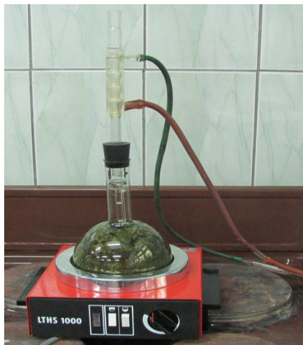
Рис. 13. Перегонка эфирных масел с водяным паром из зеленой массы базилика
