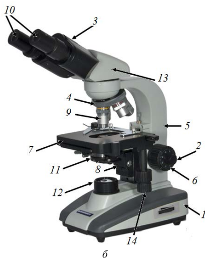
Рис. 1. Устройство биологического микроскопа: a – Биолам; б – Микромед; 1 – подставка; 2 – микровинт; 3 – тубус; 4 – револьвер; 5 – штатив; 6 – макровинт; 7 – предметный столик; 8 – кронштейн конденсора; 9 – объектив; 10 – окуляр(ы); 11 – конденсор; 12 – осветительный прибор (зеркало, лампочка); 13 – бинокулярная насадка; 14 – винты для перемещения предметного столика в горизонтальной плоскости
