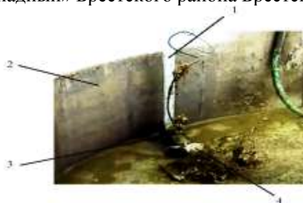
Рис. 1. Миксер для навоза: 1 – стойка, 2 – навозохранилище, 3 – миксер, 4 – мешалка
