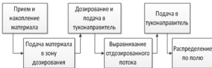
Рис. 1. Пооперационная схема работы удоброческих машин
