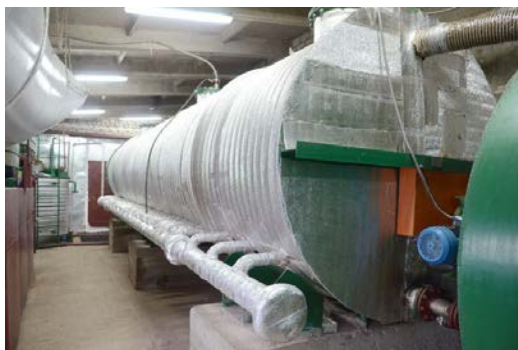
Рис. 1. Биогазовый реактор производства ООО «СельхозБиоГаз»
