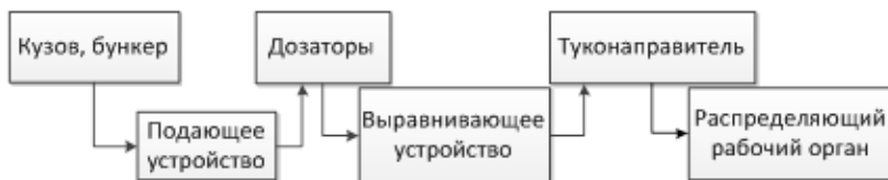
Рис. 2. Элементная схема машин для внесения удобрений
