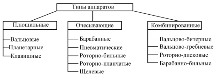
Рис.1. Классификация устройств, применяемых для отделения семенных коробочек
