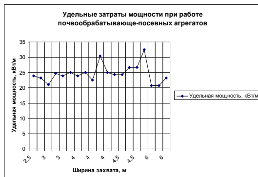
Рис. Диапазон удельных затрат мощности почвообрабатывающе-посевными агрегатами различной ширины захвата
