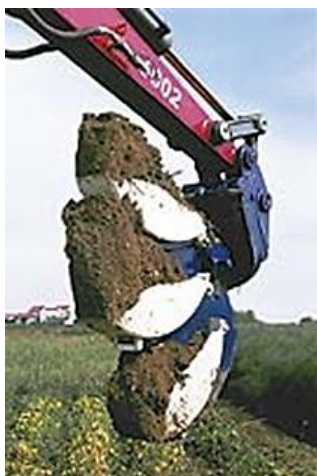
Рис. 1. Конструкция ковша для рытья узких траншей
