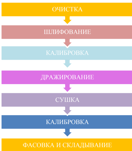
Рис. 1. Этапы производства дражированных семян
