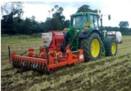
Рис. Фронтальное расположение технологической емкости для жидких удобрений в составе комбинированного почвообрабатывающе-посевного агрегата
