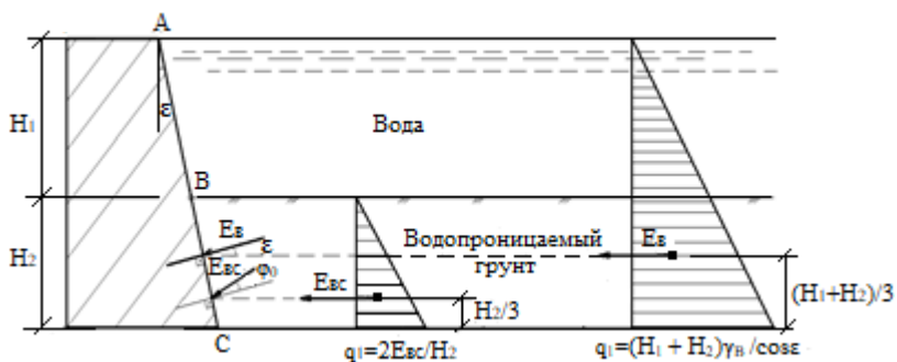
Рис. 11.15. Эпюра гидростатического давления воды q = f(H) = f(H_1 + H_2) и эпюра интенсивности взвешенного давления грунта q_1 = f(H_2) , кН/м
