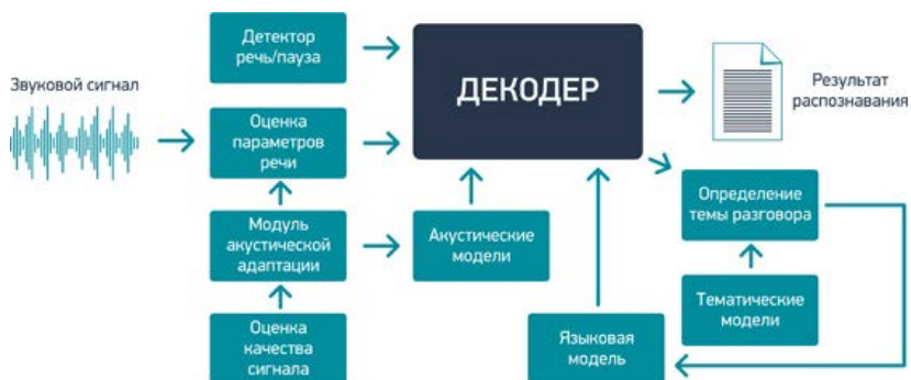
Рис. 1. Основные элементы системы для распознавания речи
